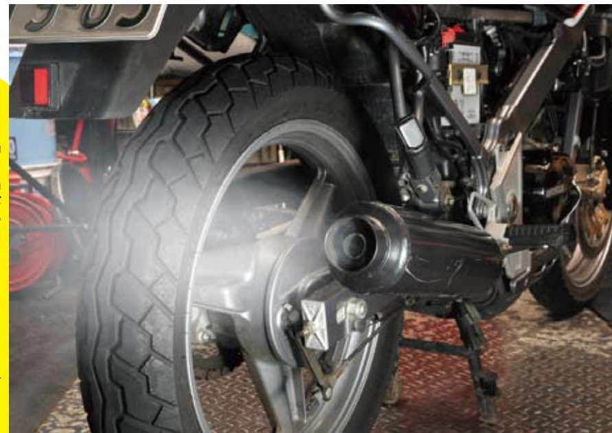
●NC-900RCRを吸い出した後、エンジンを始動させて気筒内に残ったカーボンを燃やす!
