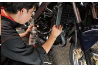
そのまま30分~1時間ほど浸けておく。今回は1時間置いておいた。アンモニアのような強烈なニオイだ
