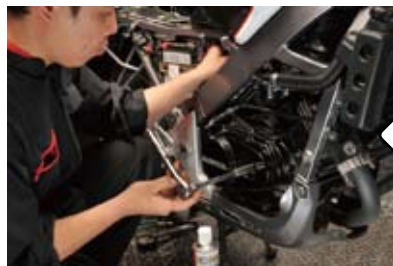
●次に液剤を両気筒内に十分充てんさせるため、ピストン位置(容量)をそろえておく。プラグホールからのぞくと、筒内は意外と汚れているような気配……
