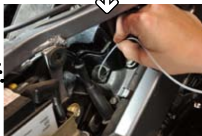
●ピストンの高さをそろえたら、燃焼室まで届くように筒内へ目いっぱい注入。フォーム状になった液剤がカーボンなどの汚れに浸透し、ふやけて落ちやすくなるよう
